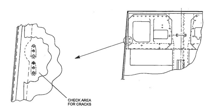
FIGURE 1 CRACK INSPECTION
